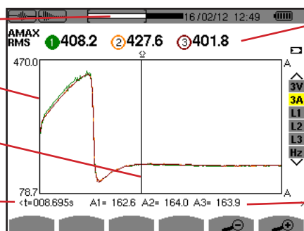
Figur 44: Skärm med 3A RMS-visning vid 3-fas anslutning med nolledare
