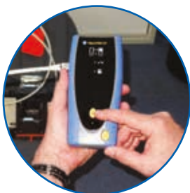
Autotest på remoteenhed for enmands betjening
