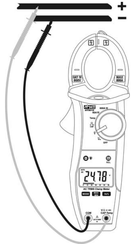
Fig. 4: Mätning av DC spänning
