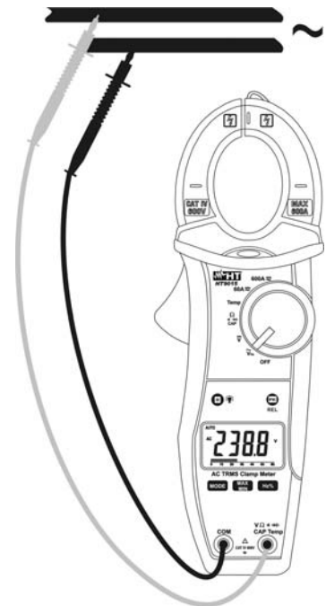
Fig. 1: Måling af AC spænding
