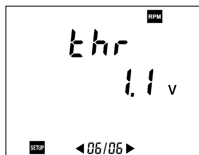
Figur 49: Visar parameter för tachometers tröskelspänning.
