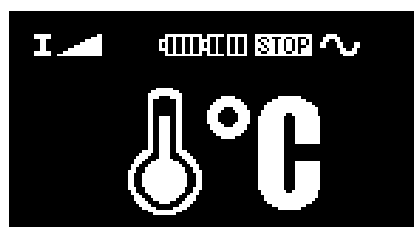
Fig. 3.7b Høj temperatur efter tryk på START knappen
