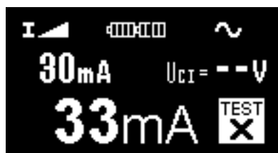
Fig. 3.16b Fasespænding er til stede på testpindene
