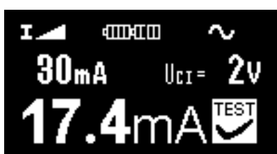
Fig. 3.15a Exempel på mätresultat för frånkopplingsströmmen
