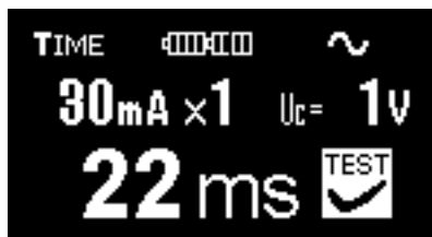
Fig. 3.12a Exempel på mätresultat för frånkopplingstiden
