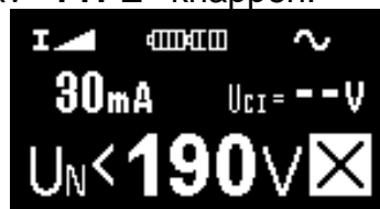
Fig. 3.14 Exempel på inställning för mätning av frånkopplingsströmmen
