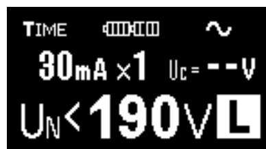
Fig. 3.16b Fasspänning finns på testpinnarna
