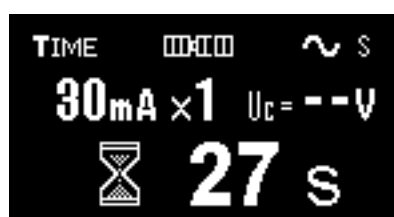
Fig. 3.13 Eksempel af nedtælling for selektive relæer
