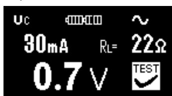
Fig. 3.10 Eksempel på berøringsspænding måleresultat
