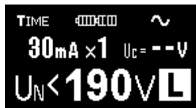
Fig. 3.15b Eksempel af måleresultat – RCD kobler ikke
