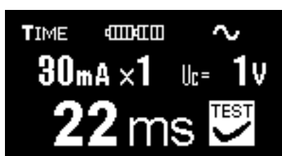
Fig. 3.12a Eksempel af måleresultat for udkoblingstiden
