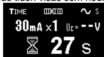
Fig. 3.13 Exempel på nedräkning för selektiva reläer
