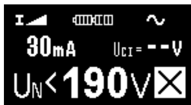
Fig. 3.14 Eksempel af opsætning for måling af udkoblingsstrømmen
